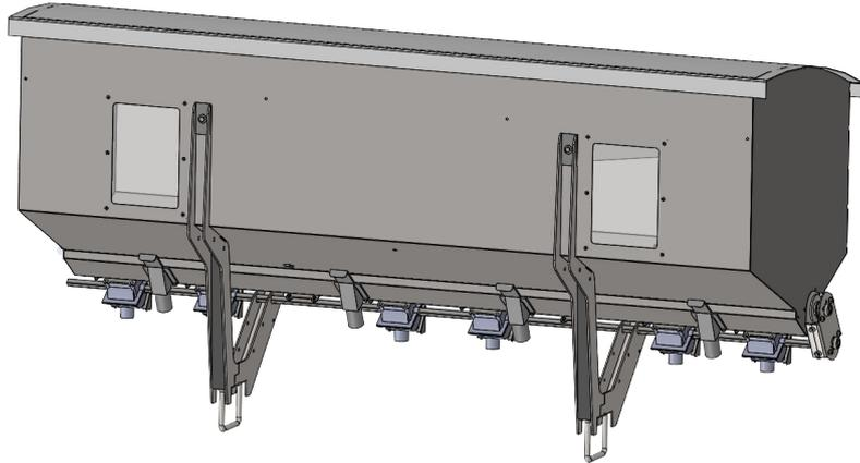
Epandeur pour engrais granulaire avec doseur volumétrique avec entrainement mécanique et trémie en acier inox. La distribution peut être réglée par une lame à réglage manuel, ou par la variation électronique ou hydraulique des tours du distributeur.
